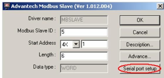
10. 选取 [NOPARITY,8,1]，按一下 [OK] 以结束所有设定。现在 ADAM-5510KW 系列控制器能透过 COM4，以 Modbus/RTU 通讯协议来存取 ADAM-4015T。
